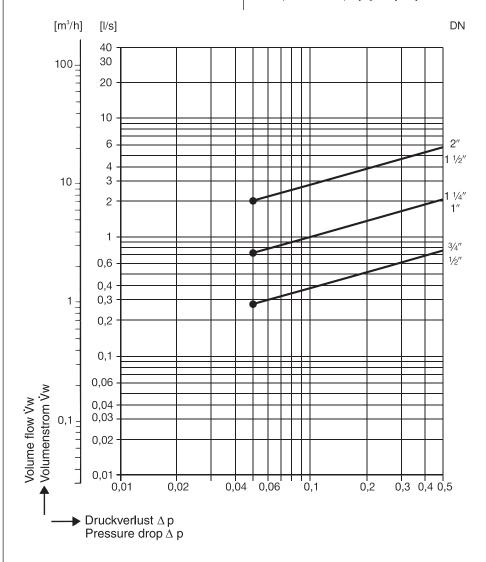
Erforderlicher Mindestvolumenstrom V., für Geräte mit Standardfeder für den Betrieb in horizontalen Rohrleitungen.
